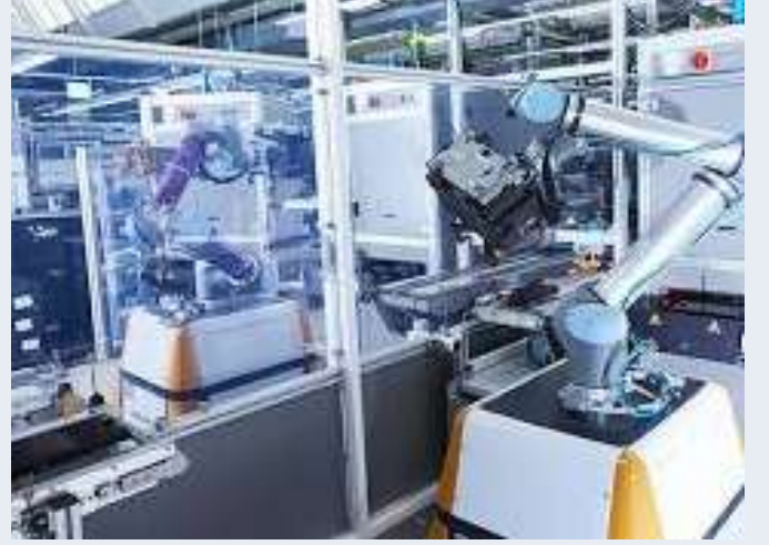
Görsel 1: Bir üretim hattında operatör ile yan yana güvenle çalışan bir cobot.
