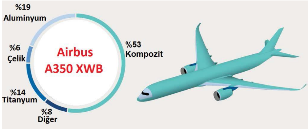
Şekil 2. Airbus A350 XWB Uçağındaki Malzeme Dağılımı [10]
